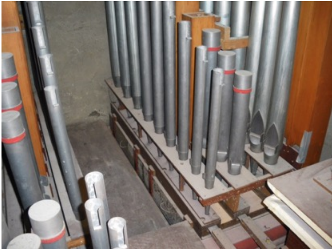
C en Cis-lade van het Pedaal met links op de voorgrond de lade voor de toegevoegde tonen f-f 1 .
